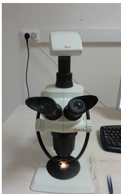
Фигура 3.5.2. Стерео микроскоп с поглед отгоре и отстрани осветление (Yogaz, 2015 г.)
